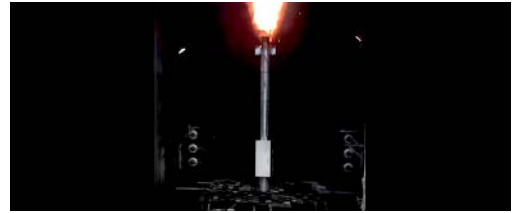
PRUEBAS DE CONTENCIÓN PARA FALLAS DE ARCO
